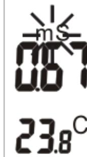
8. 在測量模式下，LCD螢幕上的測量單位將持續閃爍，直至儀器讀值穩定後，LCD螢幕上的單位則停止閃爍。
